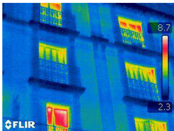
Reprises visibles de l'étanchéité des balcons du R+2
